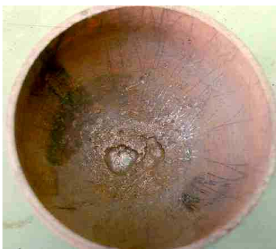
Lochfrass im Boden einer Taucherflasche
